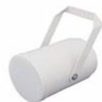
Proiettore per sistemi di evacuazione vocale, certificazione EN54 pt24. Potenza nominale 20W@100V. SPL 86 (dB). Per uso interno/esterno (Tipo A/B) IP33C. Potenza regolabile (20/15/10/5W). Montaggio a parete o soffitto. Corpo in alluminio. Completo di morsetti ceramici e fusibile termico. Dimensioni ø140x200mm. Colore bianco RAL 9010.
