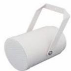
Proiettore per sistemi di evacuazione vocale, certificazione EN54 pt24. Potenza nominale 10W@100V. SPL 92 (dB). Per uso interno/esterno (Tipo A/B) IP33C. Potenza regolabile (10/6/3/1,5W). . Montaggio a parete o soffitto. Corpo in ABS. Completo di morsetti ceramici e fusibile termico. Dimensioni ø140x200mm. Colore bianco RAL 9010.
